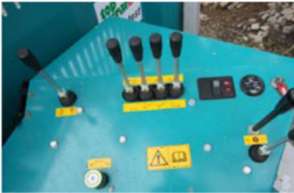
Die „Kommandozentrale“ mit Hydraulikschalthebeln.
