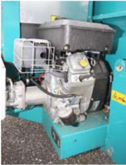
Der 18 PS-Benzinmotor des Testgerätes.
